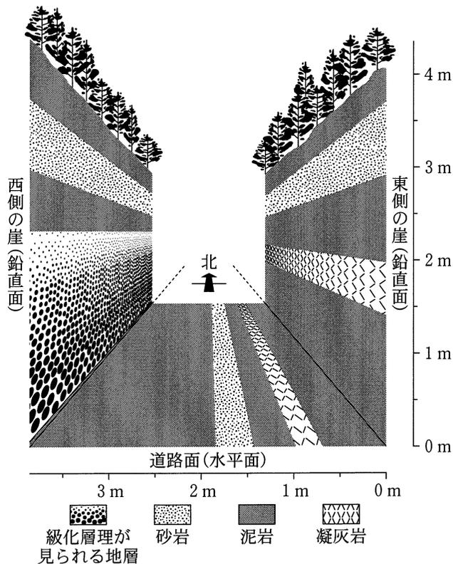
図 1 地点 P での工事中の道路の壁面と道路面に見られる地層のスケッチ
