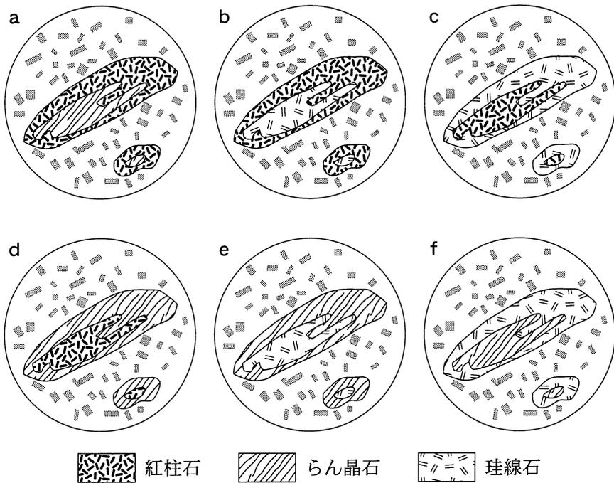
図3 共存する2種類の  $\text{Al}_2\text{SiO}_5$  鉱物の組織
