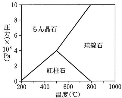
図 2 紅柱石、らん晶石、珪線石が安定になる温度と圧力の領域
